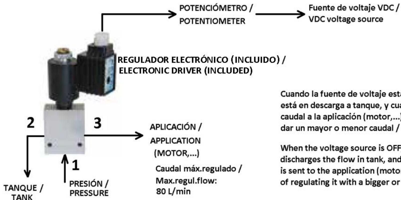
Cuando la fuente de voltaje está apagada, el regulador está en descarga a tanque, y cuando se conecta manda caudal a la aplicación (motor,...) con la posibilidad de dar un mayor o menor caudal /
